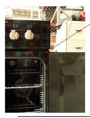
REMOVE THE 2 SECURING SCREWS FOR THE TOP HINGE AS SHOWN
